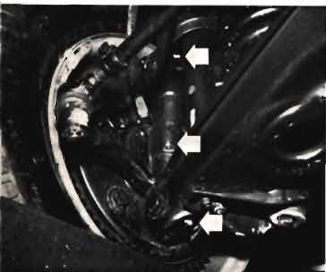
Am Achsschenkel müssen rechts und links je 3 Nippel abgeschmiert werden (siehe Pfeile)
