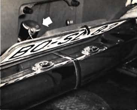
Der Tankeinfüllstutzen ist sichtbar, wenn das hintere Nummernschild abgezogen wird.
