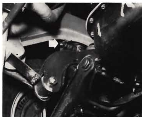
Am oberen Querlenker vorne muß rechts und links jeweils ein Nippel abgeschmiert werden (siehe Hinweispfeil).
