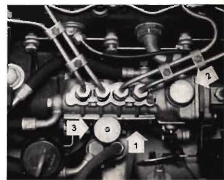
Einspritzpumpe: Pfeil Nr. 1 Ölstandkontrolle; Nr. 2 Entlüftungsfilter; Nr. 3 Handpumpe.
