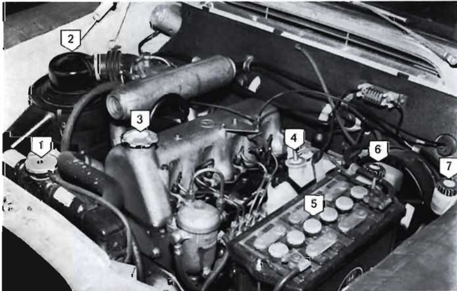
1 = Kühlerverschraubung; 2 = Ölbad-Luftfilter; 3 = Motoröleinfüllung; 4 = Behälter für Scheibenwaschanlage; 5 = Batterie; 6 = Behälter für hydr. Bremse; 7 = Behälter für hydr. Kupplung.
