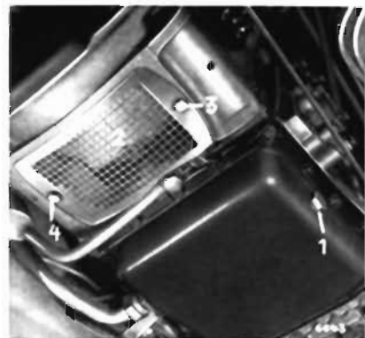
1 Getriebe-Ölablaßschraube 2 Kupplungsgehäusedeckel 3 Befestigungsschrauben 4
