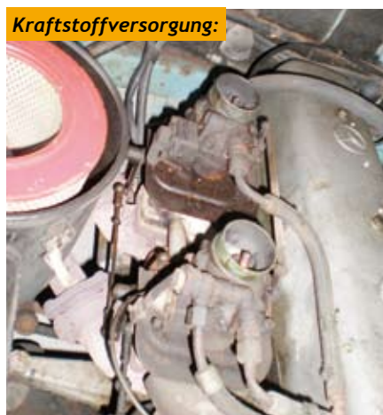
2-fach-Fallstromvergaseranlage mit Solex 34 PICB im 220b
