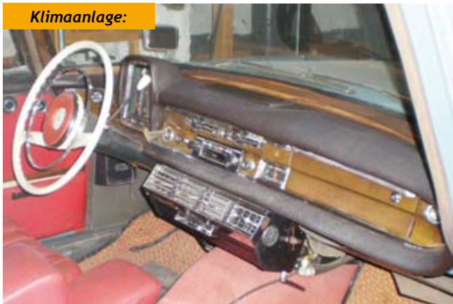
Ein 220 Sb mit der seltenen SA Klimaanlage Typ Frigette
