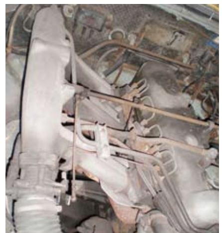
Frühe Ausführung mechanische Bosch- Benzineinspritzung im 220 SEb
