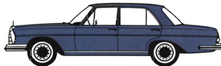
300 SEL 3.5 · 200 ch/DIN · Moteur V8 de 3,5 l avec injection d'essence à commande électronique.
