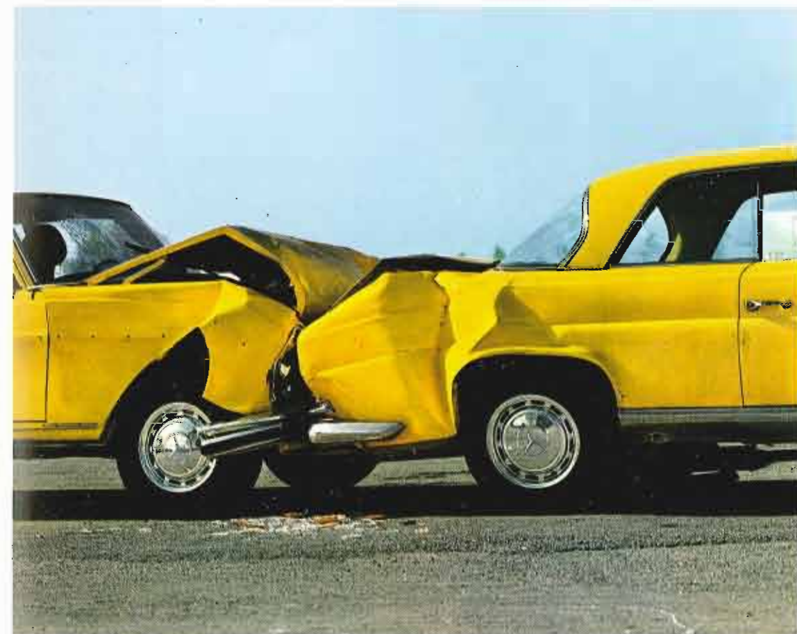
Auffahrversuch im Rahmen der umfangreichen Sicherheitsforschung
