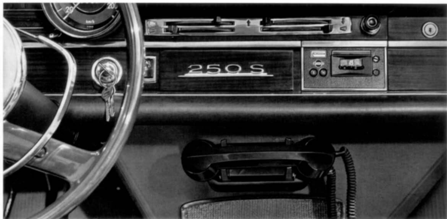
Trommelbediengerät, eingebaut in die Aschenbecheröffnung am Armaturenbrett
