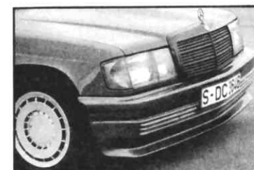
Zender-190 E: wenig Auftrieb durch voluminösen, nach vorne gerichteten Frontspoiler
