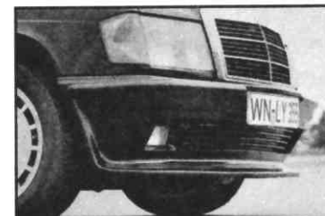
Lorinser-190 E: harmonisch angepaßte Spoiler, vorne mit integrierten Nebelscheinwerfern
