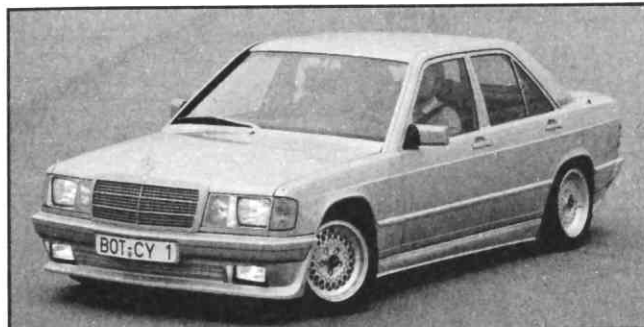
AMG-190 E: breite Version mit neu montierten vorderen Kotflügeln aus Kunststoff
