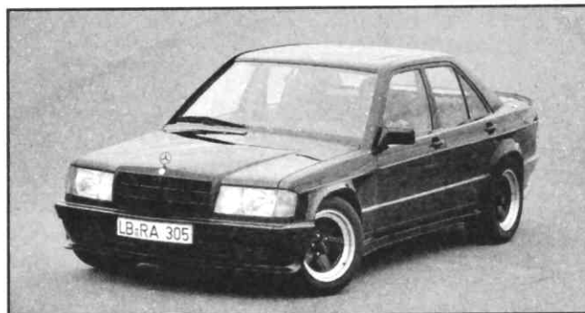
AMG-190 E: breite Version mit neu montierten vorderen Kotflügeln aus Kunststoff
