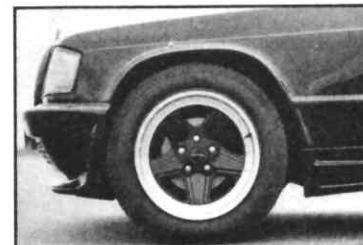
AMG-190 E: breite Version mit neu montierten vorderen Kotflügeln aus Kunststoff
