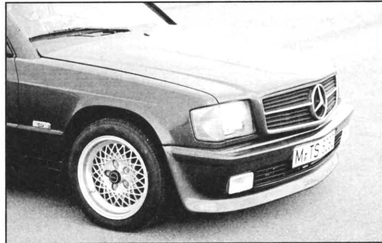
Motorhaube und Spoiler bestehen aus Kunststoff
