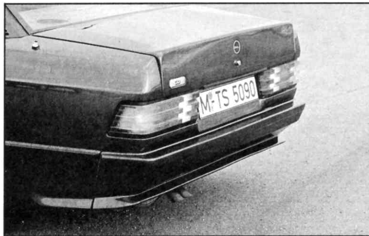
Kunststoff-Kofferraumdeckel mit Abrißkante
