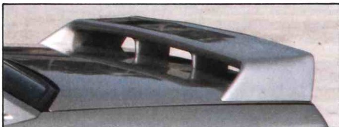
Der Heckspoiler verringert den Auftrieb an der Hinterachse
