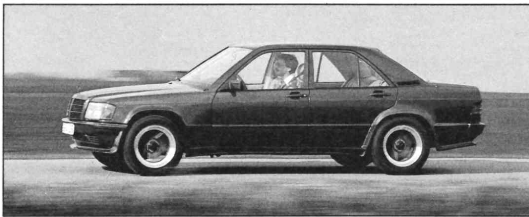
Ohne Heckspoiler ist der c_w -Wert des breiten 190 geringfügig schlechter
