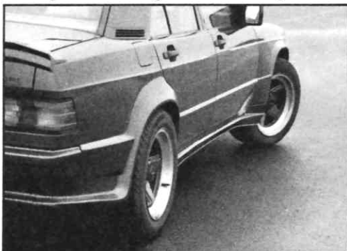
Kotflügelverbreiterungen und Seitenschweller
