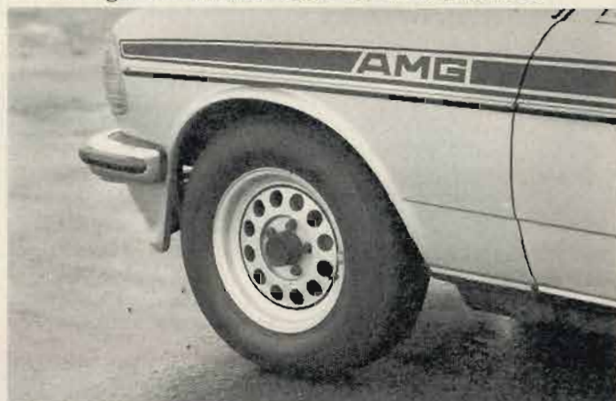
Leichtmetallräder mit 205/70 VR 14-Gürtelreifen
