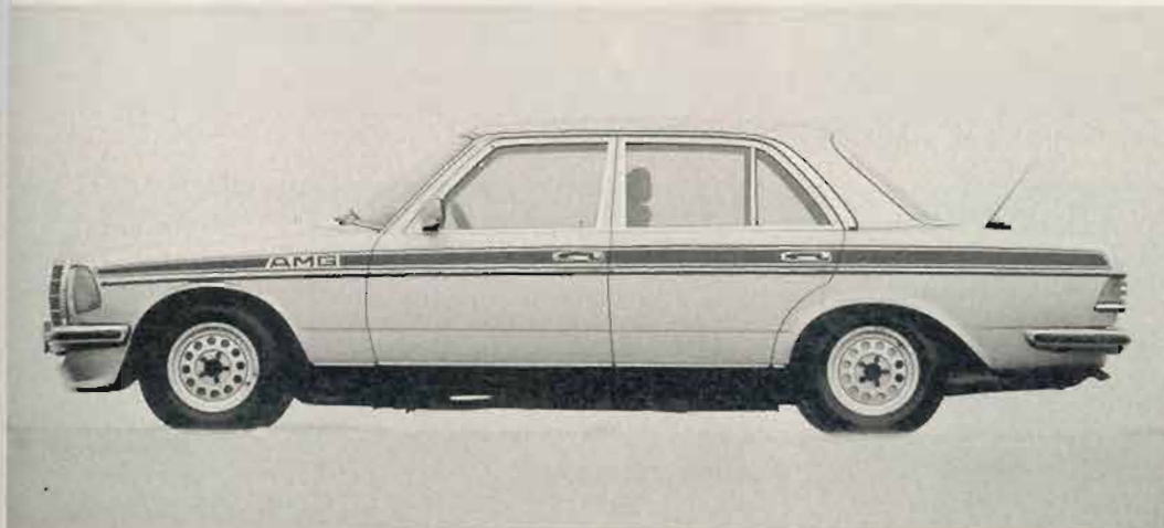
Der Aufbau des AMG-Mercedes wurde um drei Zentimeter tiefer gelegt
