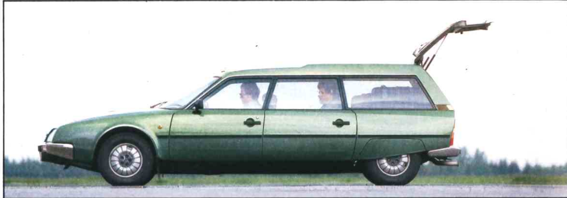
Citroën CX IE Break: gleichbleibende Bodenfreiheit durch hydropneumatische Federung, unübertroffen
