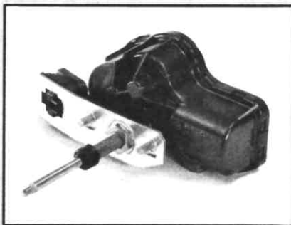
km 53 633: Heckscheibenwischer-Motor ausgetauscht
