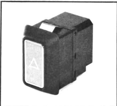
km 75 309: Warnblinkschalter erneuert
