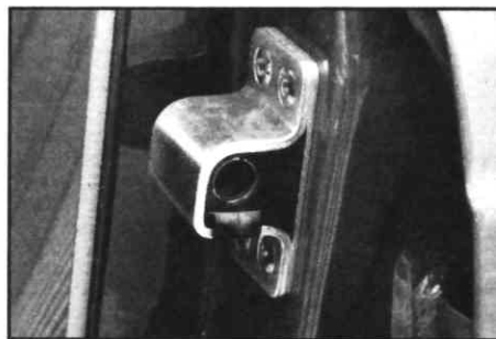
Besonders solide: Zapfen-Türschloß am Mercedes 240 D
