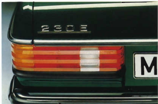
Das charakteristische Querrillenprofil vermindert die Verschmutzung der Heckleuchten.
