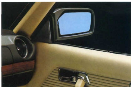
Der große, von innen elektrisch verstellbare, rechte Außenspiegel.
