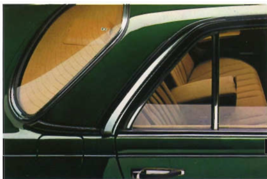
Verdeckt angeordnete Luftaustrittsöffnungen sorgen für wirbelfreie Entlüftung.
