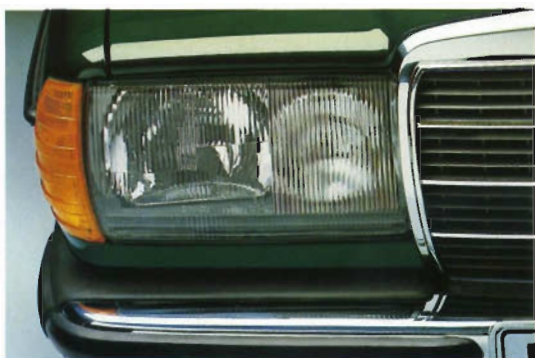
Halogen-Scheinwerfereinheit mit integrierter Nebelleuchte und seitlich herumgezogener Blinkleuchte.
