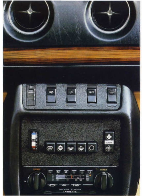
Die elektronisch gesteuerte Klimatisierungsautomatik hält die einmal vorgewählte Temperatur im Wageninneren konstant.
