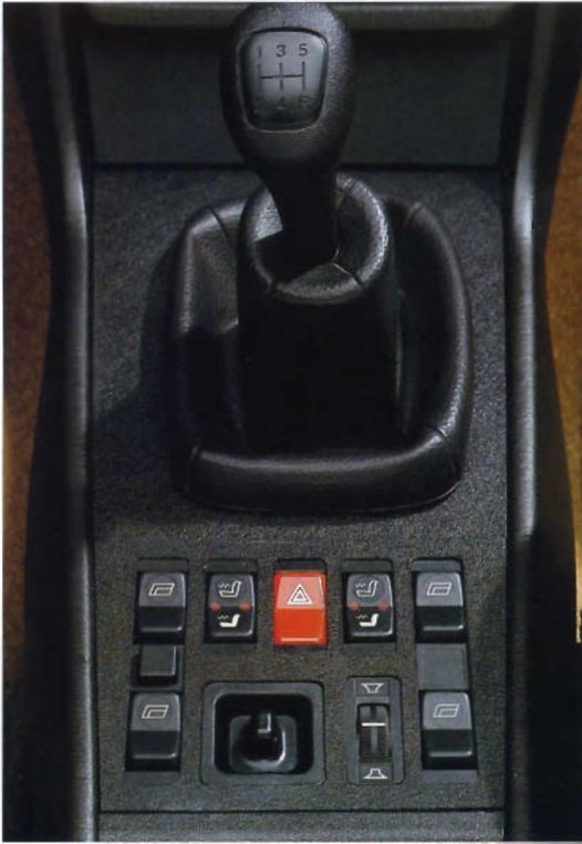
Die Mittelkonsole mit dem Wählhebel des kraftstoffsparenden 5-Gang-Getriebes und den Bedienelementen.
