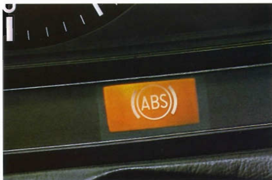
Das auf Wunsch lieferbare Anti-Blockier-System (ABS) sorgt auch auf nasser, schneeglatte oder vereister Fahrbahn für optimale Bremswirkung bei Erhaltung der Lenkfähigkeit.
