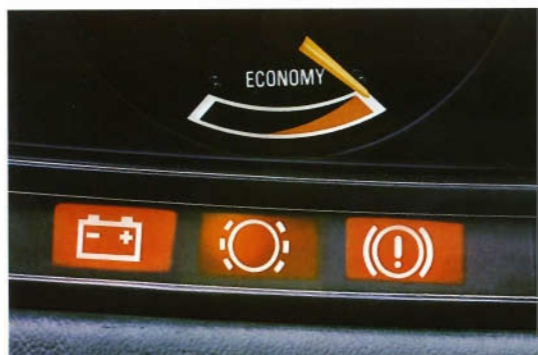
Die Bremsbelag-Verschleiß-Anzeige weist Sie rechtzeitig auf den fälligen Belagwechsel hin.
