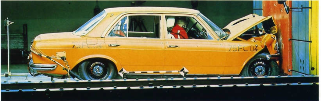
Die Knautschzonen mit gestaffelten Festigkeitszonen bieten bei Front- und Heckaufprall größtmögliche passive Sicherheit.
