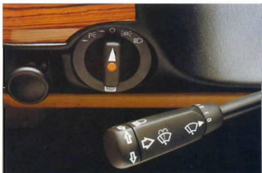
Beispiele für sinnvolle Konzentration der Bedienelemente sind der Lichtdrehhalter und der Kombischalter.
