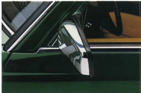
Aerodynamisch verkleidete, von innen verstellbare Außenspiegel.
