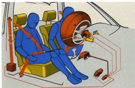
Die Funktionsweise des auf Wunsch erhältlichen, elektronisch gesteuerten Rückhaltesystems Airbag und Gurtstrammer.
