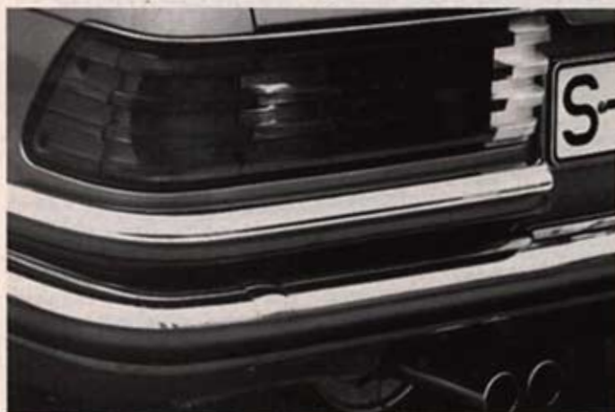
Geriffelte Leuchten: Sie strahlen auch dann noch, wenn die üblichen glatten vollständig „zugekleistert“ sind.
