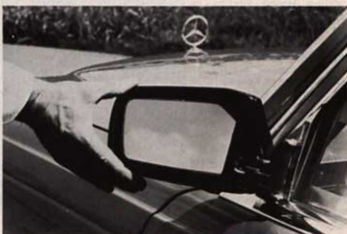
Der Außenspiegel läßt sich über eine einfache Mechanik von innen verstellen. Dennoch kann der ganze Spiegel bei einem Anprall nach vorn oder hinten wegklappen.
