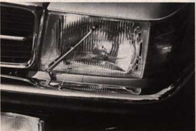
So etwas wird bei neuen Fahrzeugen mehr und mehr erscheinen: Eine Wasch- und Wischanlage für die Scheinwerfer. In Winter ist sie geradezu ein Segen!
