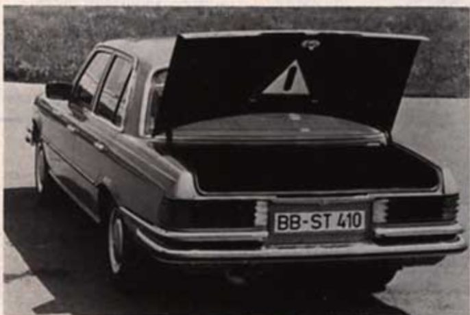
Einfache Idee, man muß nur darauf kommen: Warndreieck im Kofferraumdeckel. Die Idee erspart sogar das sonst nötige Gehäuse für das Dreieck!
