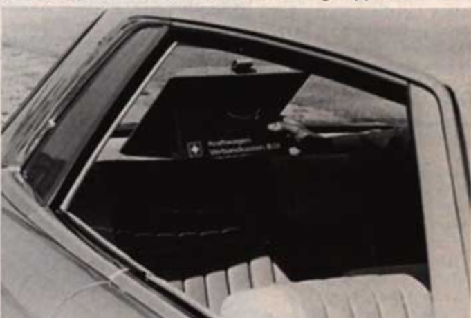
Ebenfalls einfache Idee: Raum in der hinteren Hutablage für den Verbandkasten. Er fliegt nicht lose im Wagen herum, man muß ihn im Ernstfall nicht erst aus dem Kofferraum ausgraben.
