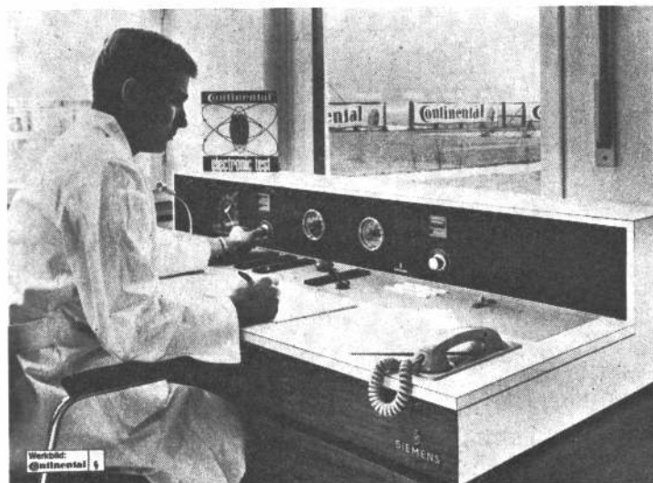
Auf dem Steuer- und Kontrollpult für Automatik- und Individualtest befinden sich die Betätigungselemente für die Wahl der Geschwindigkeit, mehrere Bremseneinstellungen (unter anderem Schnellstopp), Betriebskontroll-Lampen, Signaltaste und Programmgeber
