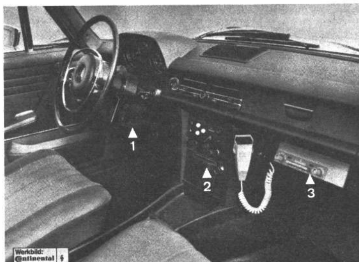
Auf dem Steuer- und Kontrollpult für Automatik- und Individualtest befinden sich die Betätigungselemente für die Wahl der Geschwindigkeit, mehrere Bremseneinstellungen (unter anderem Schnellstopp), Betriebskontroll-Lampen, Signaltaste und Programmgeber
