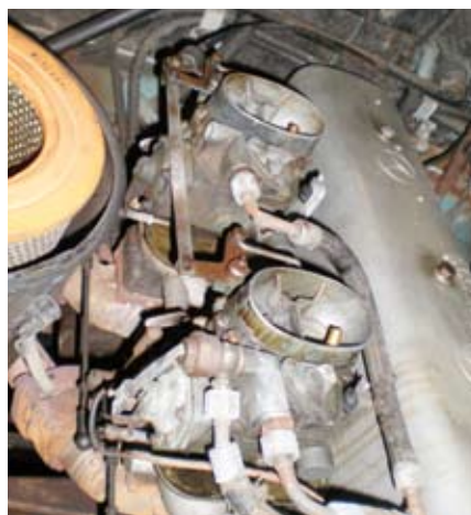
Frühe Ausführung 2-fach-Register-Fallstrom- vergaseranlage mit Solex 34 PAITA im 220 Sb
