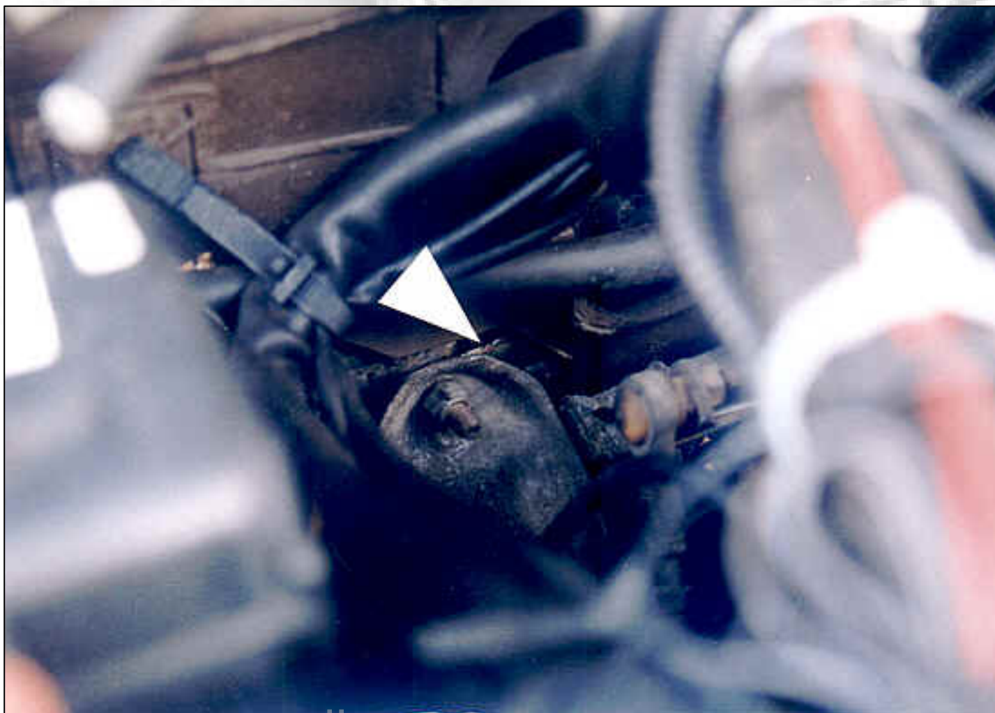
Bild unten: „Versteckter Riss der Vorderachsaufhängung“ (gleiches Auto wie Seite 5 oben, nur vor dem Zerlegen!)
