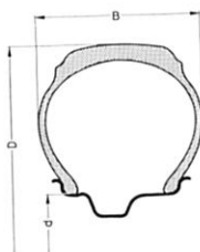
Niederquerschnitt-Reifen Verhältnis Höhe : Breite ca. 0,85 : 1
