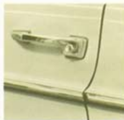
Gummileiste an beiden Seiten, um den Lack zu schützen.
