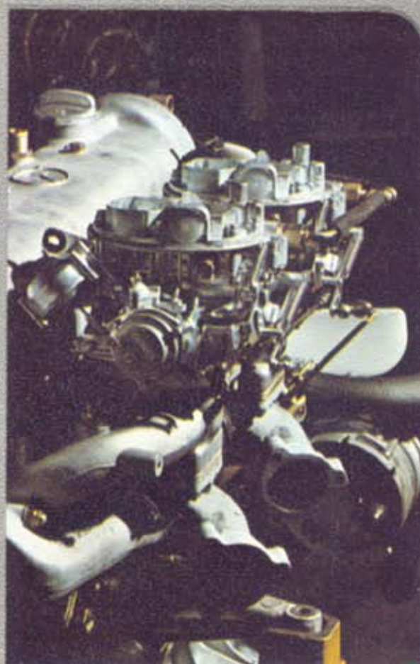
Zwei Register-Fallstromvergaser des 250. 130 PS/DIN, 96 kW, 146 gr. HP/SAE
