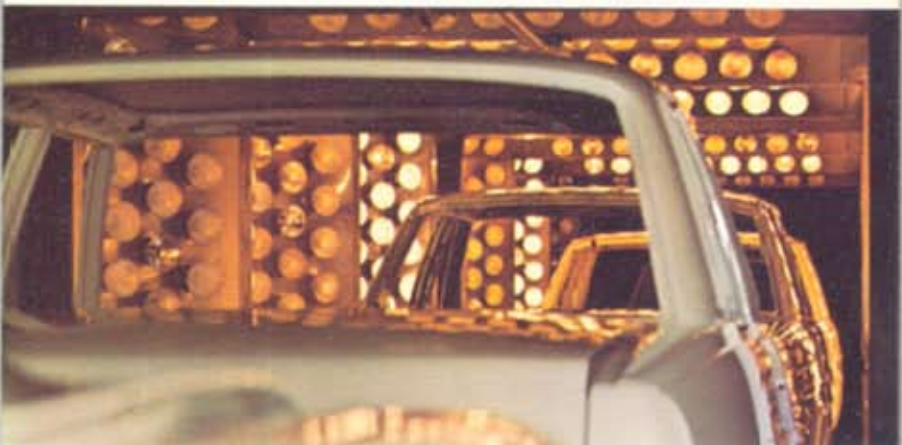
Einbrennen der Lackschichten zwischen 130° und 165° C
