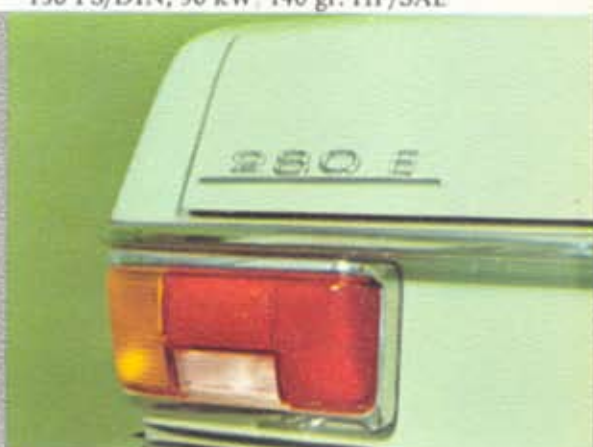
Getrennte Stromkreise für alle Leuchten
