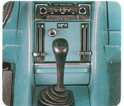
Der 350 SL wird serienmäßig mit mechanischem Getriebe und Mittelschaltung geliefert. Auf Wunsch: 3-Gang-Wandler-Automatic.
