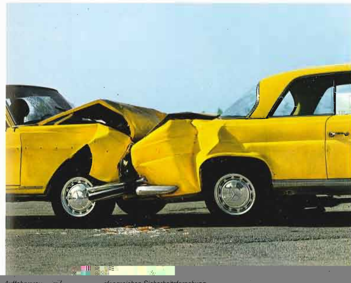
Auffahrversuch im Rahmen der umfangreichen Sicherheitsforschung
