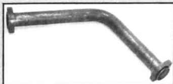
km 80 915: Vorderes Auspuffrohr erneuert
