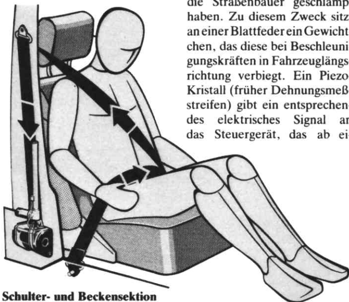
Mit zwei Gramm Pulver in zwölf Millisekunden 18 Zentimeter Kolbenweg
