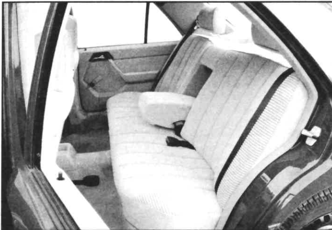
Neue Vordersitzlehnen für mehr Knieraum hinten
