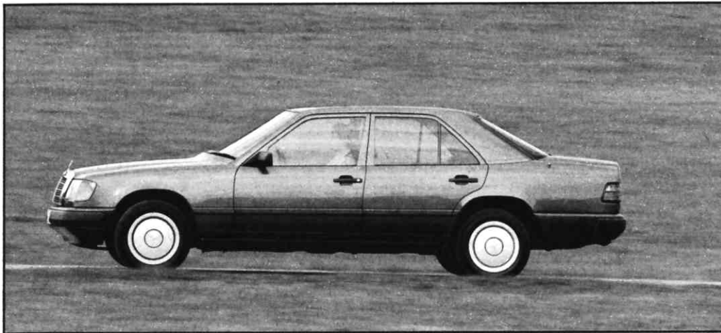
Zeichen guter Aerodynamik: Flach gestellte Front- und Heckscheibe sowie das hochgezogene Heck
