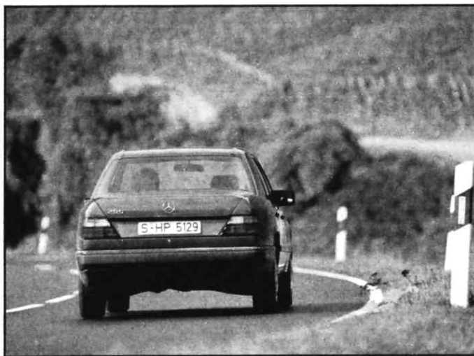
Zeichen guter Aerodynamik: Flach gestellte Front- und Heckscheibe sowie das hochgezogene Heck
