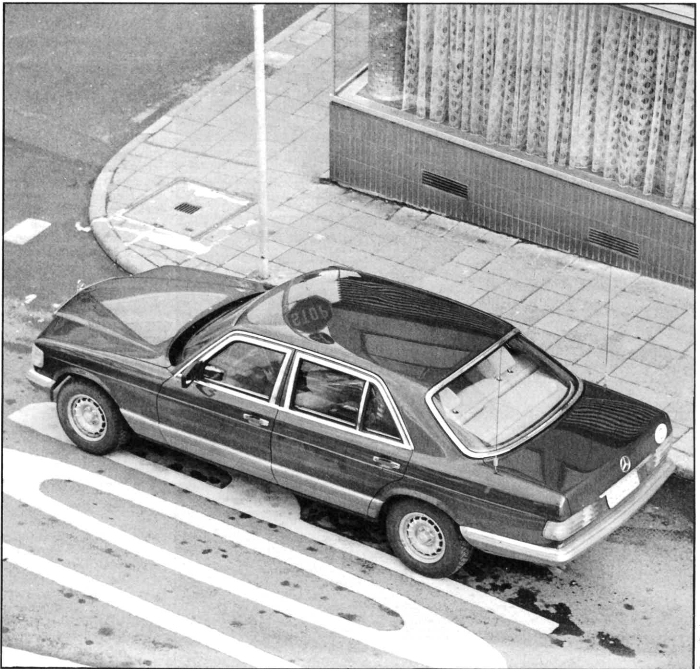
Äußerlich nur an den breiteren Fenstereinfassungen erkennbar: Mercedes-Panzerwagen im Straßenverkehr
