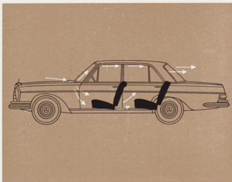
Zugfreie Be- und Entlüftung bei geschlossenen Fenstern
