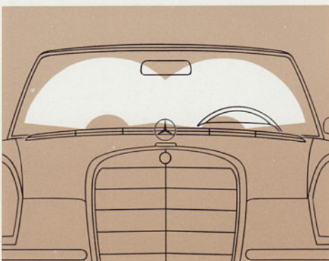
Große, gegenläufige Scheibenwischer mit 2 Wischgeschwindigkeiten, wirkungsvolle Scheibenwaschanlage
