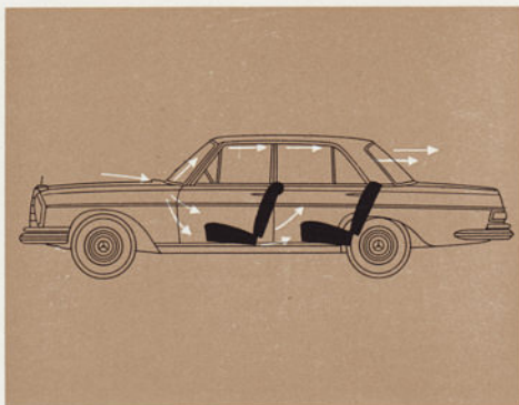
Zugfreie Be- und Entlüftung bei geschlossenen Fenstern
