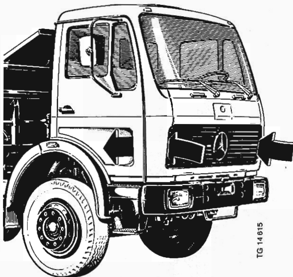
Bild 31: Luftleitdüsen und Regenleisten zur Vermeidung der Eigenverschmutzung
