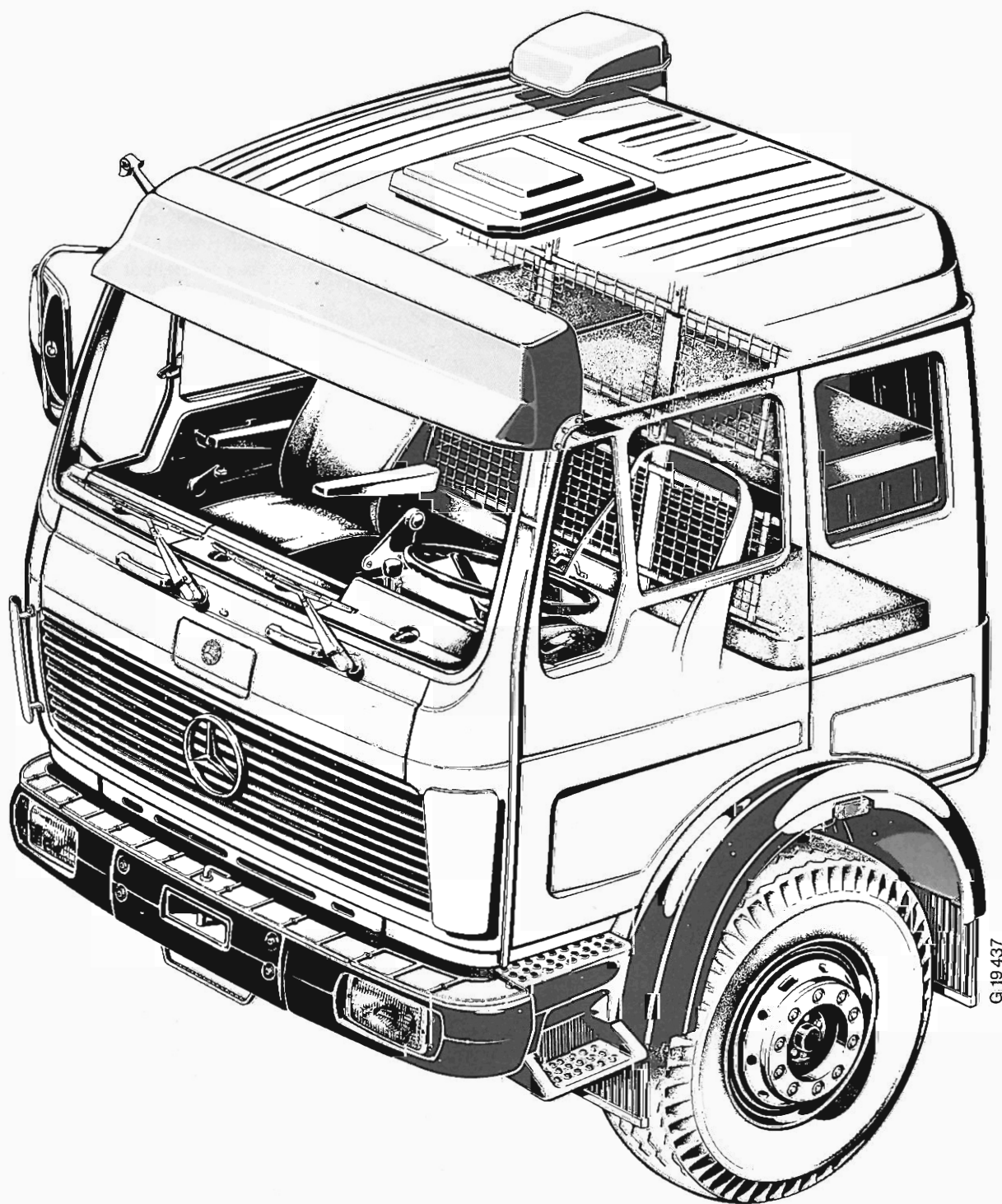
Bild 43 Großraumfahrerhaus kippbar FK 8/6
