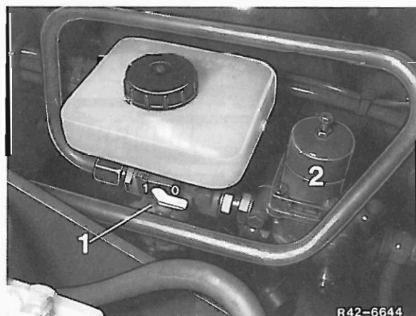
Bild 43/40 1 Automatische Frostschutzpumpe 2 Druckregler
