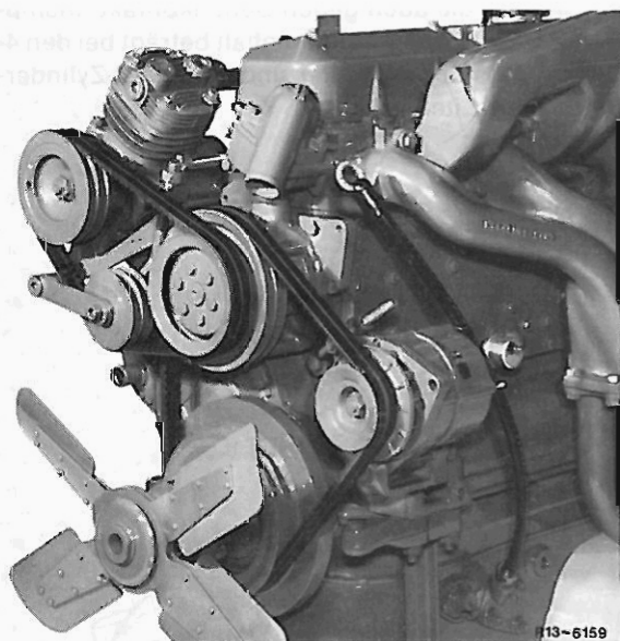
Bild 00/19 Riementriebe, Kurbelwelle, Wasserpumpe, Drehstromgenerator, Luftpresser
