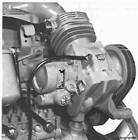
Bild 00/21 Anbau riemengetriebener Luftpresser mit Lenkhelfpumpe
