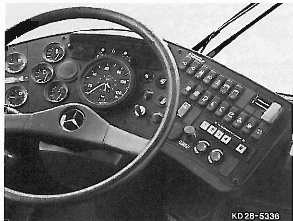
Instrumententafel O 402: In der Mitte ist der Fahrtsschreiber mit integrierter Zeituhr angeordnet.
