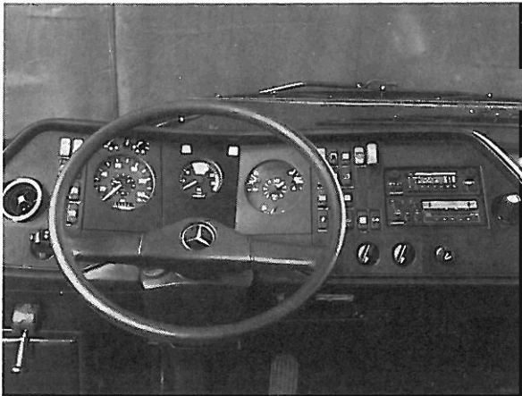
Instrumententafel O 402: In der Mitte ist der Fahrtsschreiber mit integrierter Zeituhr angeordnet.
