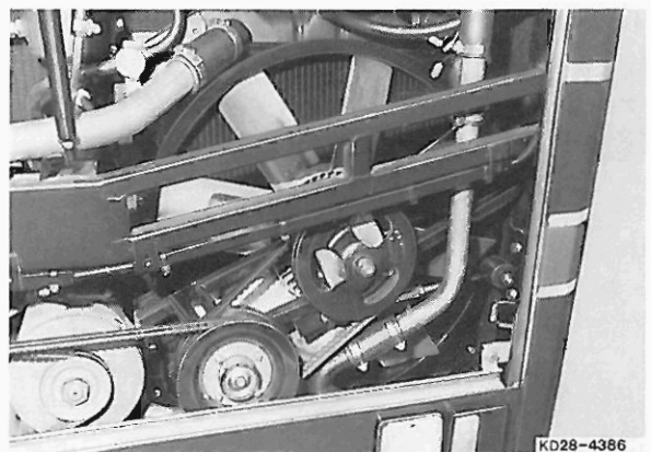
Kühler und Lüfter
