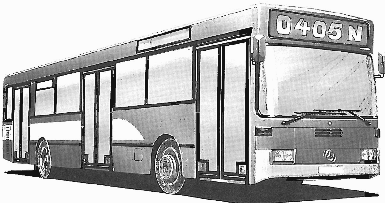
O 405 N Aufbau-Baumuster 357.817 (drei Türen)
