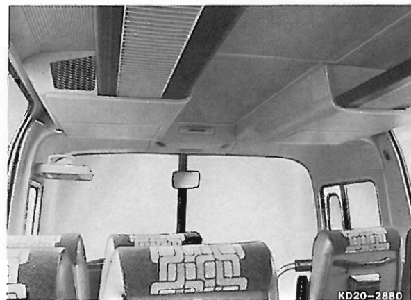
Direkt Austritt und gelochte Deckenverkleidung
