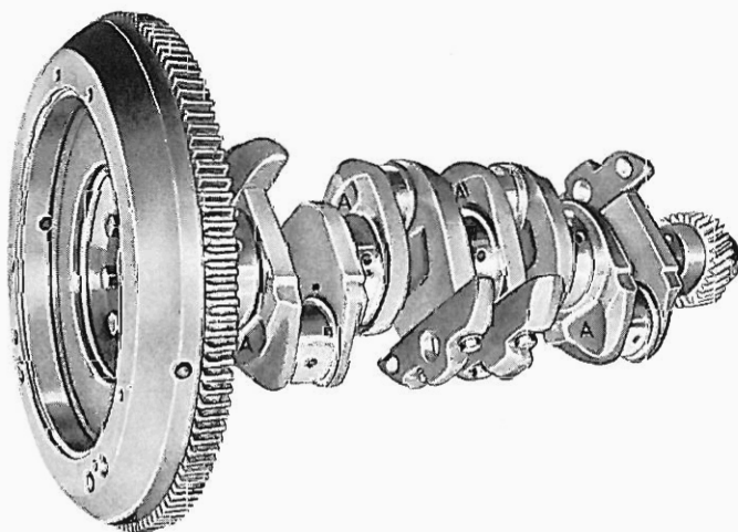
Bild 9 Kurbelwelle A Nierenförmige Ausfräsung
