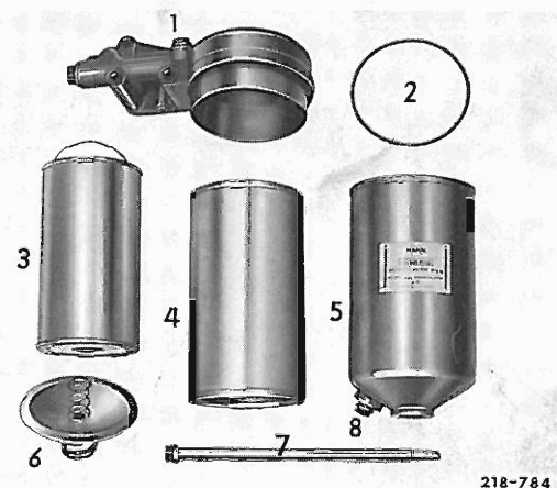
Haupt- und Nebstromfilter
