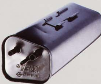
Der Aktivkohlefilter speichert Kraftstoffdämpfe und gibt sie bei laufendem Motor in das Kraftstoffsystem zurück.
