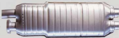
Serienmäßig: der geregelte Dreiweg-Katalysator der dritten Generation.
