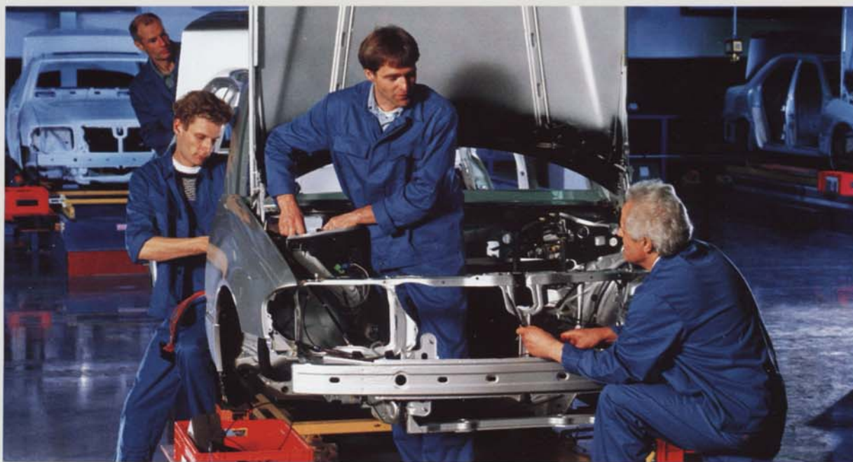
Eine variable Produktionsstraße der PKW-Karosseriemontage in Sindelfingen.
