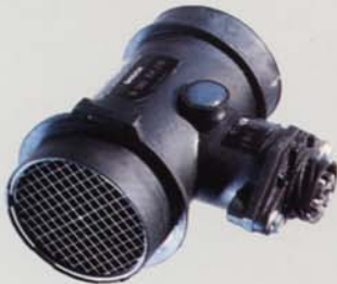
Der Heißfilm-Luftmassenmesser optimiert das Kraftstoff-Luft-Gemisch des E 220 und E 320.
