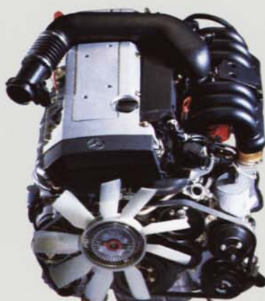
Die 4-Ventil-Benzinmotoren: der Vierzylinder des E 220 und der Sechszylinder des E 320.
