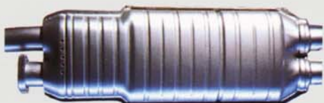
Bei Mercedes-Benz Fahrzeugen mit Benzinmotor schon seit Jahren serienmäßig: der Dreiweg-Katalysator.
