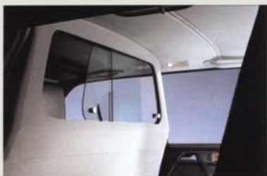
Die fest eingebaute Trennwand mit Schiebefenster.
