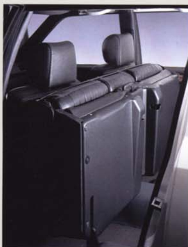
Der doppelte Klapp-Mechanismus für die mittlere Sitzreihe sorgt auf Wunsch für mehr Beinfreiheit im Fond.
