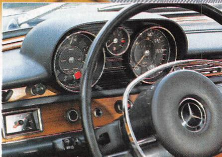
Die Uhr zwischen Tacho und Kombiinstrument wurde durch einen Drehzahlmesser ersetzt
