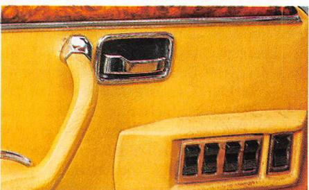
Mit der Schalterbatterie in der Fahrertür lassen sich zentral alle Fensterheber betätigen
